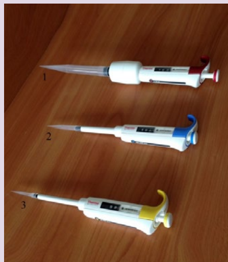
Рис. 7. Пипетки-дозаторы одноканальные переменного объёма: 1 — 1—10 мл; 2 — 100—1000 мкл; 3 — 10—100 мкл.
