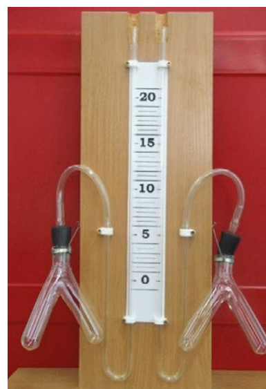
Рис. 11. Прибор для определения скорости химических реакций
